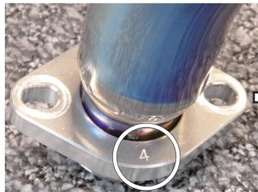
エキゾーストパイプはそれぞれ組み込むシリンダーが決まっています。フランジ部分に組み込む各シリンダーの番号が打刻されています。
