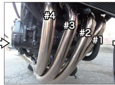
エキゾーストパイプを各シリンダーに緩めに仮組みします。(カクカクと動く程度)固定には純正マフラーの固定に使用していたフランジナットを再使用します。
