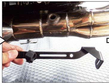
オイルパンに2点止めされている(排気ガスセンサーの配線を束ねている)ブラケットを取り外します。
