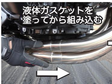
液体ガスケットを塗ってから組み込む
