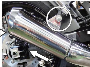
サイレンサー上部を固定しているボルトを取り外し、車体に傷をつけない様にサイレンサーボディを上下左右に揺すりながら引き抜きます。固定用のボルト類は後で再使用します。
