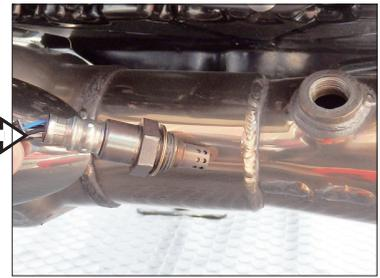
排気ガスセンサーの配線を傷めない様に注意しながらセンサーをマフラー本体から取り外します。(後で再び取り付けます。)
