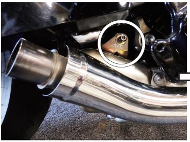
右・ステップ内側に見えるマフラー本体固定部のボルトを取り外します。工具が届かない場合にはステップの固定(2点止め)を一旦外し、ステップをずらして作業します。
