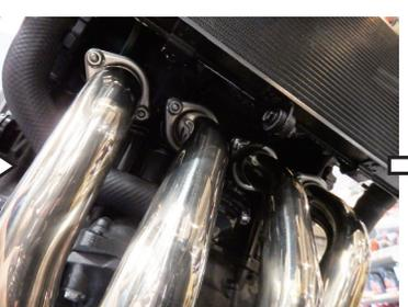
エンジン側固定部のフランジナット8個を全て取り外し、(ナットは後で再使用します)マフラー本体を車体から取り外します。重いのでゆっくりと慎重に取り外します。
