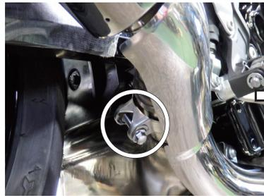
サイレンサーボディとマフラー本体との接合部のバンドを緩め、ボルトを抜き取ります。
