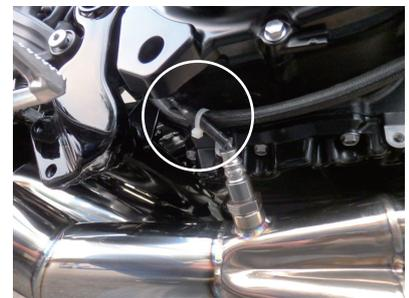
排気ガスセンサーを取り付けます。配線に無理がかからない様に注意し、しっかり本締めします。
