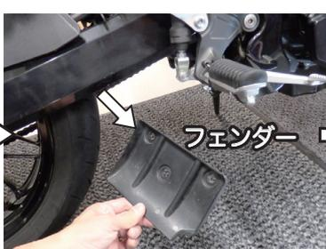
リアタイヤ前方のスイングアームに付いているフェンダーは不要になりますので取り外します。取付穴3箇所にはボルトのみを戻して使わなくなったネジ穴に蓋をしておきます。
